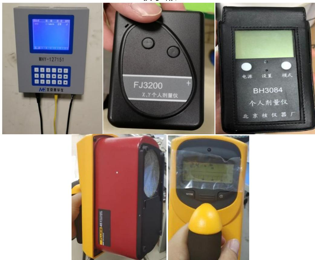
射线报警仪、个人剂量仪及辐射监测仪
